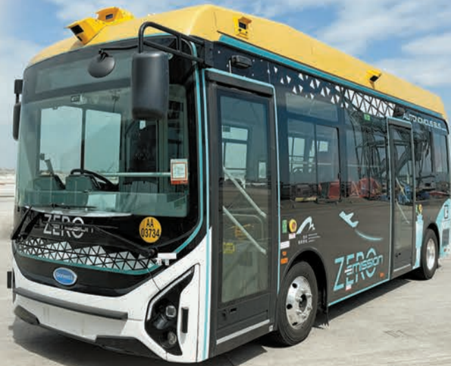
巡邏車及穿梭巴士（上圖），實際無人駕駛管運里程已超過 70 萬公里，為機場節省大量人力及成本，在惡劣戶外環境下仍能有效工作。香港商報記者 馮仁樂
