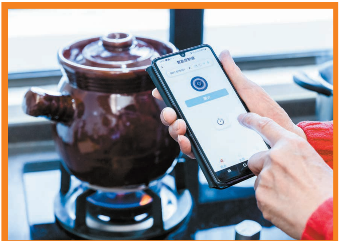
煤氣公司自主研发智能控制器，採用物聯網（IoT）技術，可連接用家現有煮食爐，用戶可透過手機監察煮食爐情況，隨時隨地遙距緊急關火。
