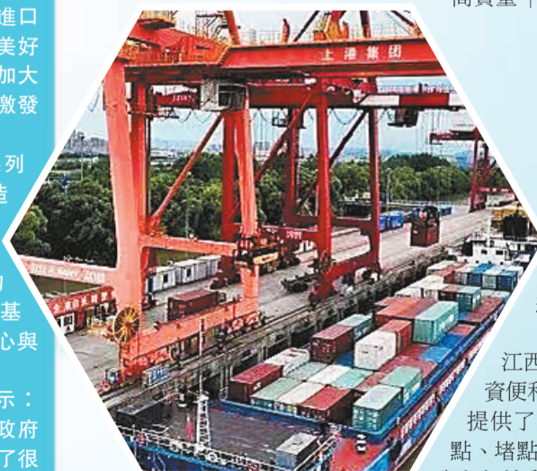
九江城西港集裝箱碼頭正在進行集裝箱裝卸作業
