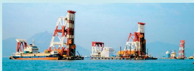
▲全球最大規模採用免挖環保填海技術「深層水泥拌合法」。
