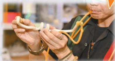
燈管加熱變軟後，可屈曲塑形，同時向管內吹氣有助定形。
