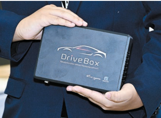
只要將小黑盒安裝在車上，便可收集行車數據，並實時傳送至DriveSense後台分析。
