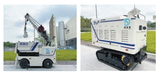
智能渠管清淤機械人「抓抓仔」和「水沖沖」。渠務署提供
