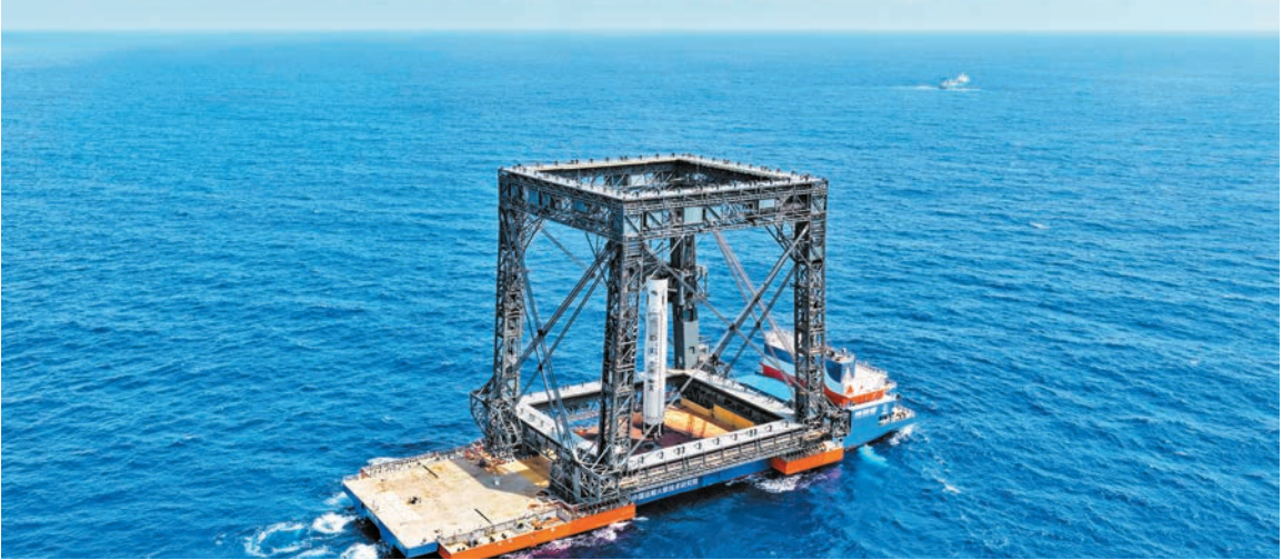
圖為海上回收平台通過網系捕獲方式成功回收長征十號乙運載火箭一子級（無人機照片）。 新華社
